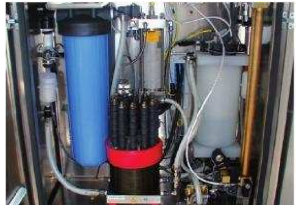
Interior de un electrolizador
